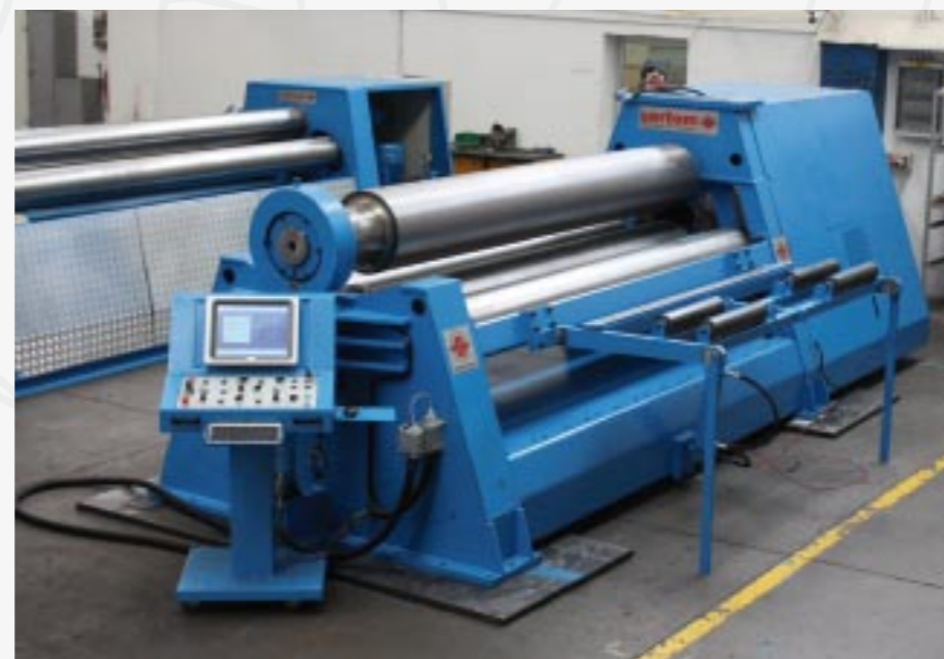
Pełne CNC sterowanie SERTOM w raz z 15" ekranem dotykowym ЧПУ Sertom с сенсорным экраном 15"
