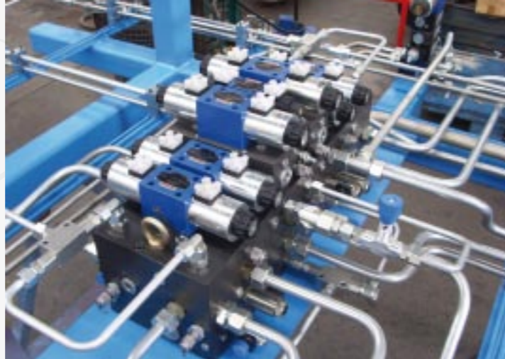
Jednostka hydrauliczna wykonana z jednego solidnego bloku i przyłączy Гидравлическая система для цельных поковков и жестких труб
