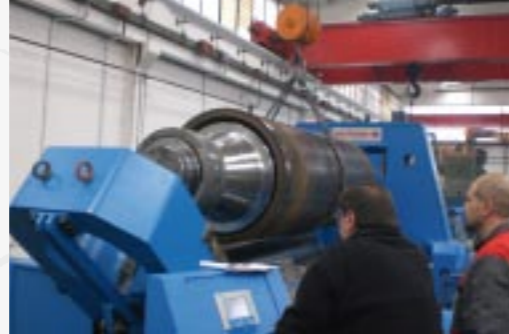
Możliwość wykonania średnic do 1,15 x średnica górnej rolki
